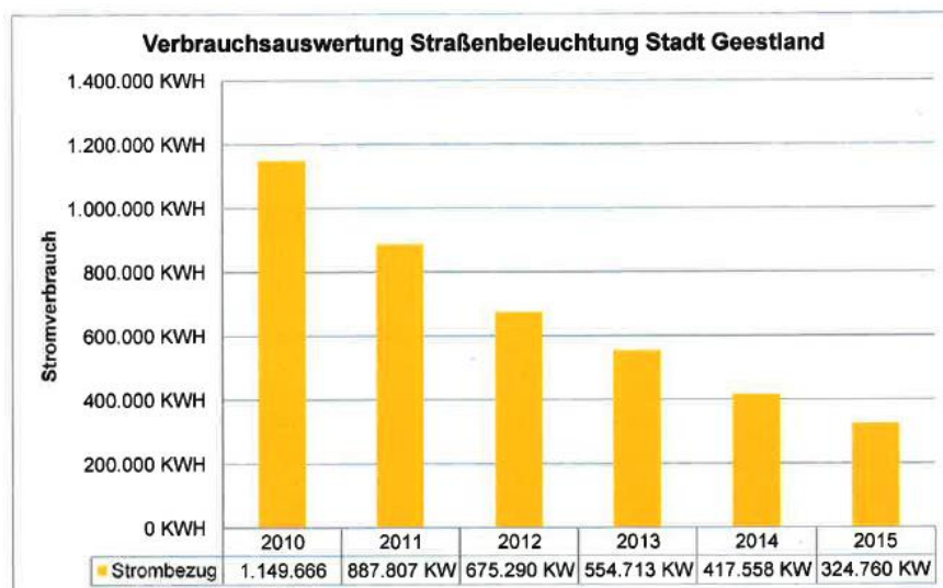
Grafik 3: Dank konsequentem Einsatz moderner LED-Technik: Reduzierung des Stromverbrauchs der Straßenbeleuchtung um 72%
