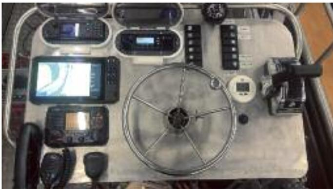
Am Fahrstand wurden neue Funkgeräte für die Kommunikation mit der Rettungsleitstelle Bremerhaven und für den DLRG internen Funk, da das alte Gerät nach 30 Jahren erneuert werden musste, installiert. Eine wirkliche Neuerung bringt ein weiteres Funkgerät, welches die Möglichkeit eröffnet, am See- und Binnenfunk teilzunehmen. Durch dieses Funkgerät kann die jeweilige Position über AIS bestimmt und gesendet und das Boot so auf den Seekarten erkannt werden.
